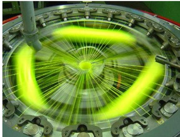
**Abb. 23: Produktionsanlage für Schläuche und Rundgewebe**
