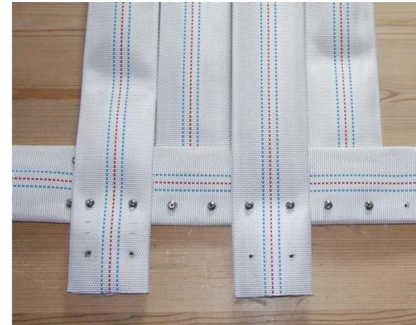
Abb. 51: Zusammenschrauben der einzelnen Schlauchteile
