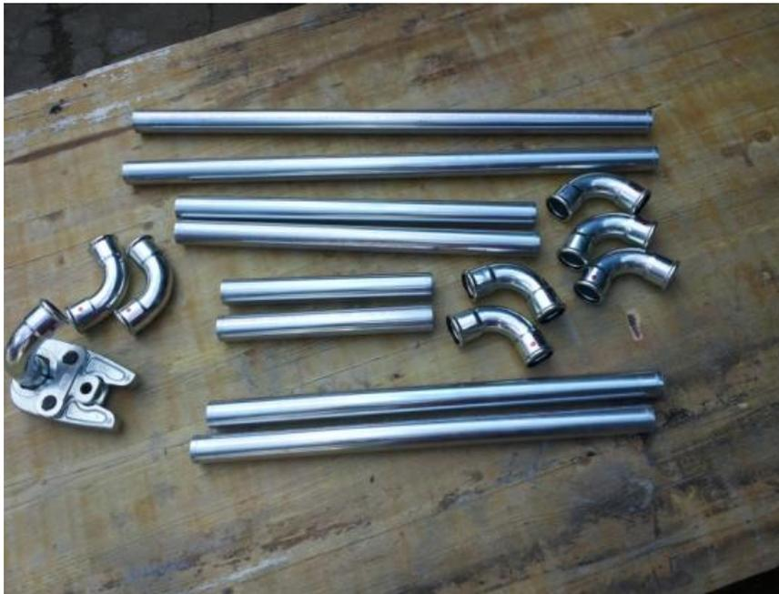
Abb. 46: Zugeschnittene Heizungsrohre und Verbindungsstücke
