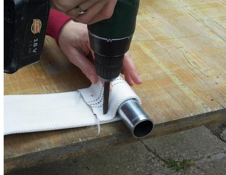
Abb. 50: Das Bohren mit dem Hohlbohrer in den Schlauch
